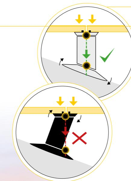
Le mouvement articulé de la base basculante KING permet de maintenir le barycentre du poids sur le support, **toujours au centre de la base**, en garantissant une plus grande stabilité du revêtement de sol.
